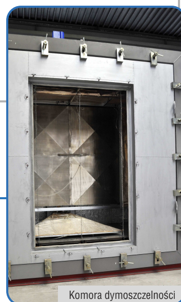
Badanie ognioodporności panelu akustycznego
