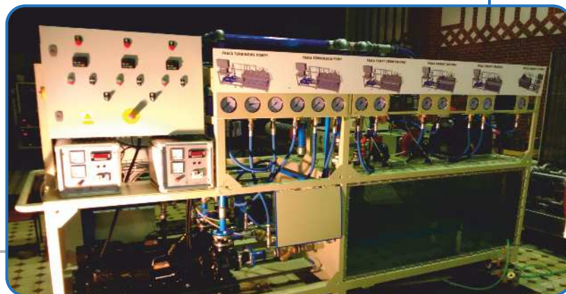
stanowisko do badania turbin wodnych
