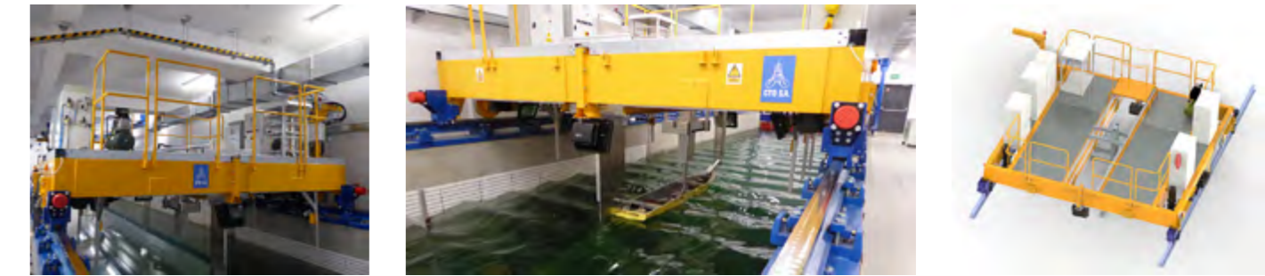
Specjalistyczne stanowisko do badań modelowych, w skład którego wchodzi m.in. pomost holowniczy z wyposażeniem badawczym oraz wywoływacz i pochłaniacz fal.
