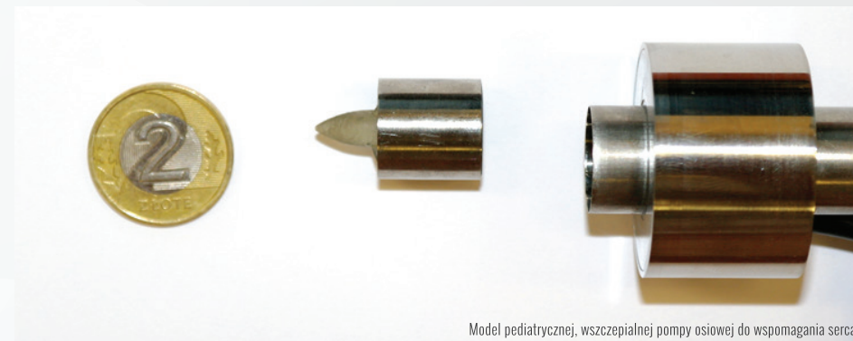
Model pediatrycznej, wszczepialnej pompy osiowej do wspomagania serca
